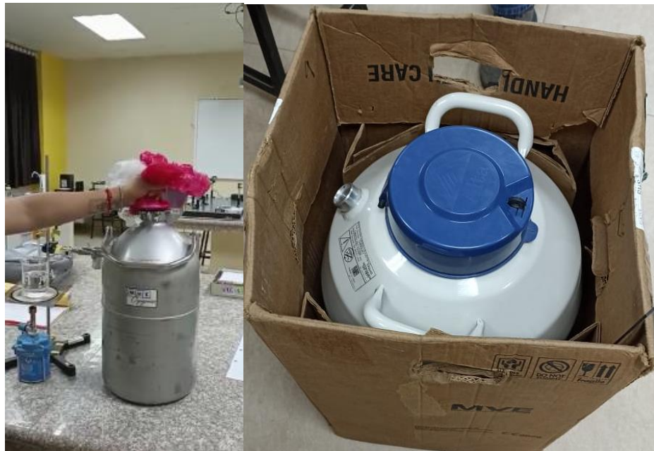
Termo de contención de muestras
