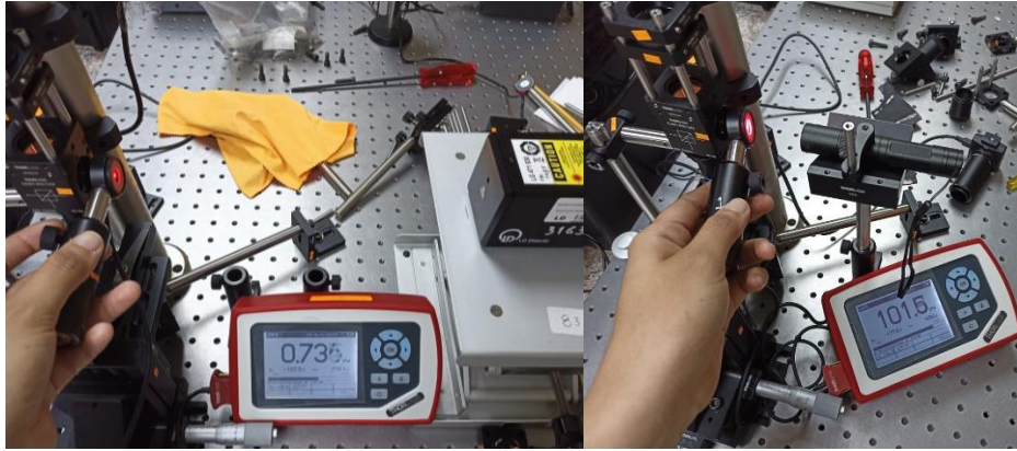
Figura 25-2. Monitoreo de la potencia del haz láser
