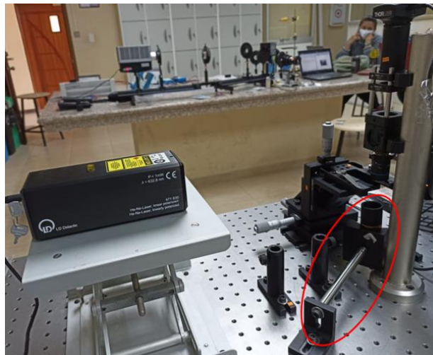
Figura 23-2. Linterna de luz fría blanca adaptada a la pinza óptica
