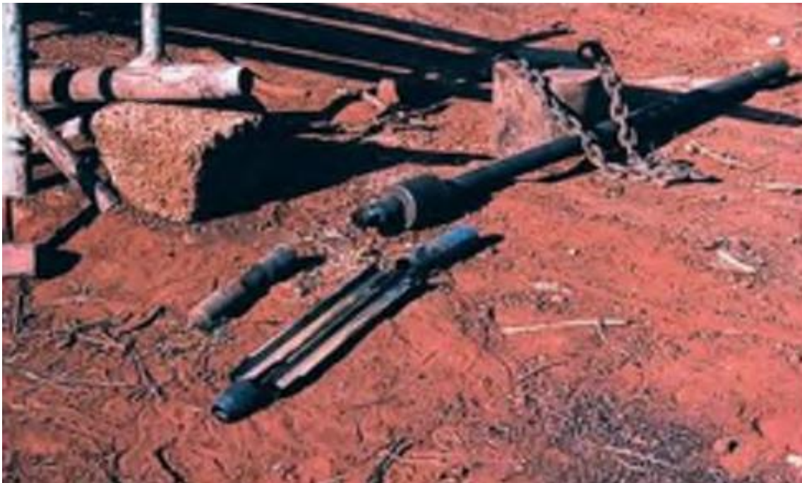
Figura 3-2: Tomamuestras, puntazas y elementos del ensayo SPT
