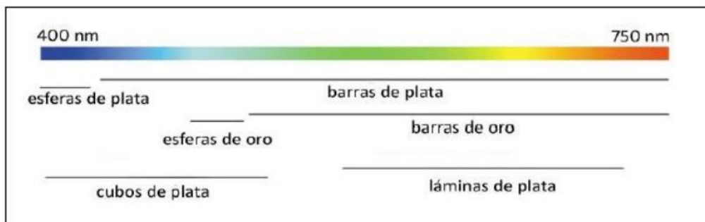
Figura 9-1. Rangos de longitud de onda UV-Vis dependiendo el tamaño y la forma de las nanopartículas de plata.
