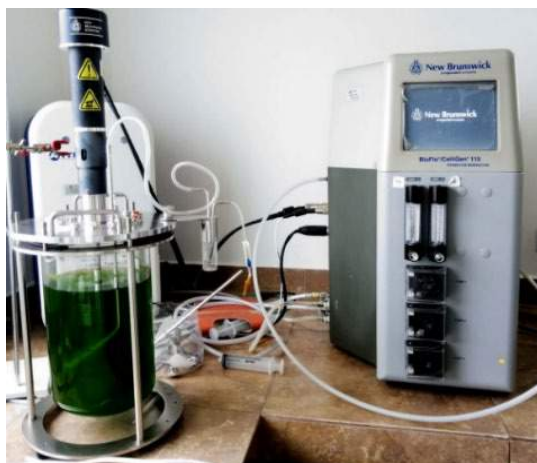
Figura 3-2: Fotobiorreactor con cultivo de Chlorella sp.
