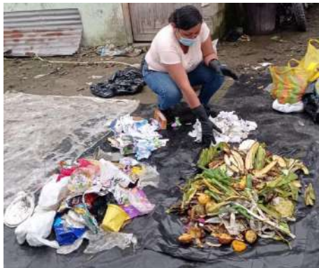
Clasificación de residuos sólidos en sus componentes de una zona de muestreo
