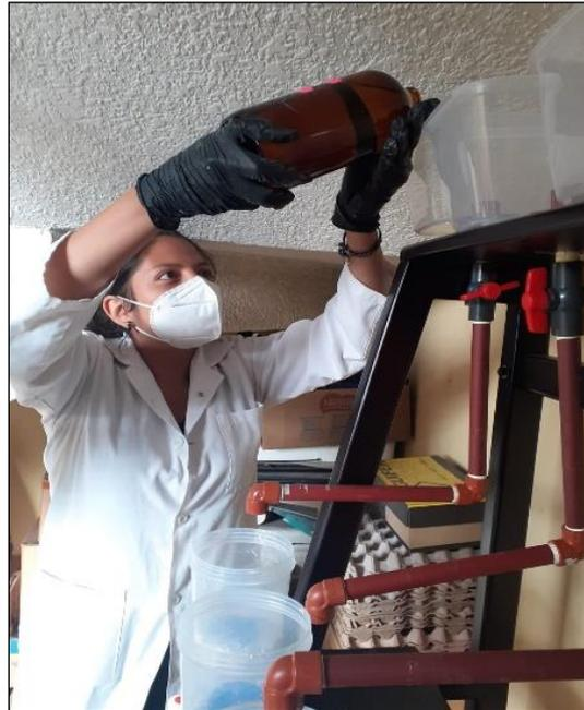
**Figura 9-3.** Adición de la muestra al sistema de filtración
