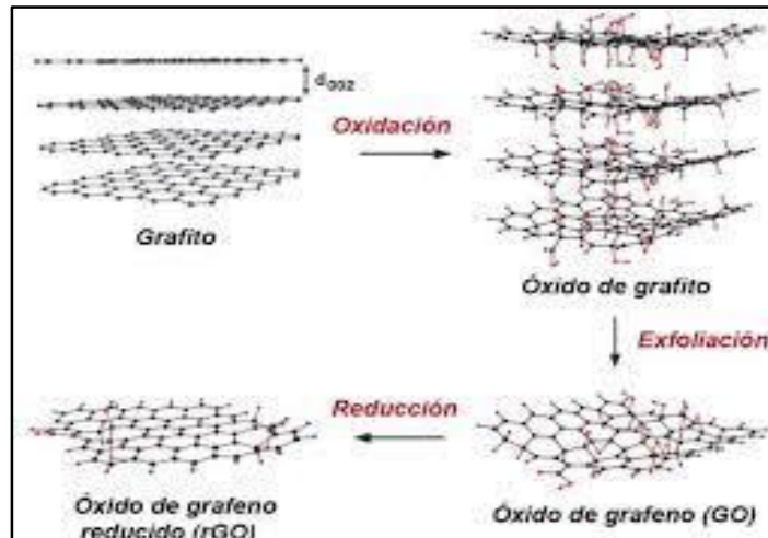
Figura 14-2: Síntesis de óxido de grafeno
