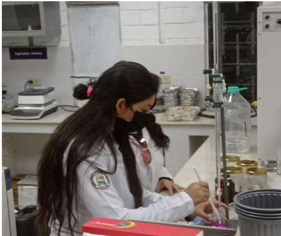
Titulación de muestras incubadas para la determinación de la respiración edáfica
