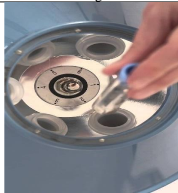
Introducción de la muestra a centrifuga
