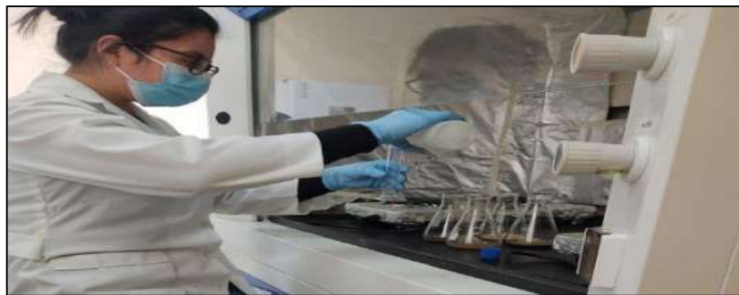
Figura 24-2: Digestión de muestras para análisis de metales pesados
