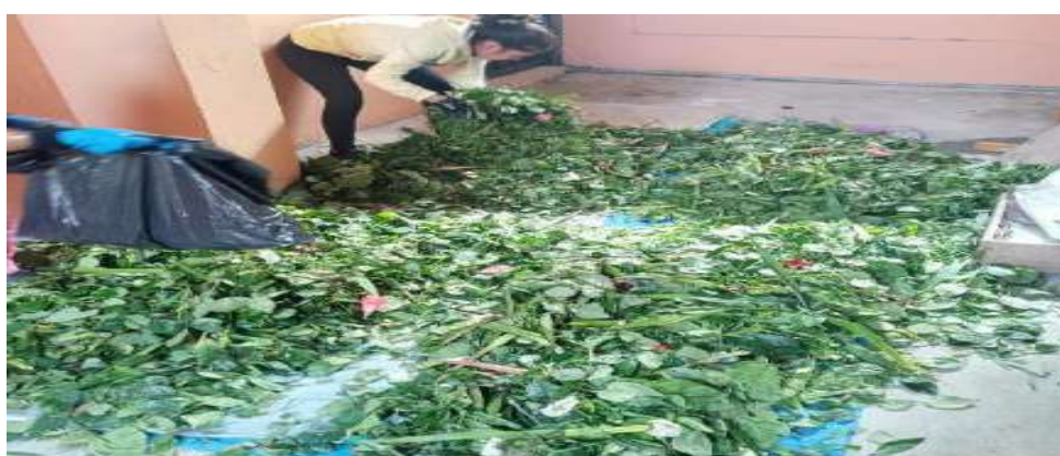
Figura 3-2: Uso del método de cuarteo para la obtención de muestras significativas
