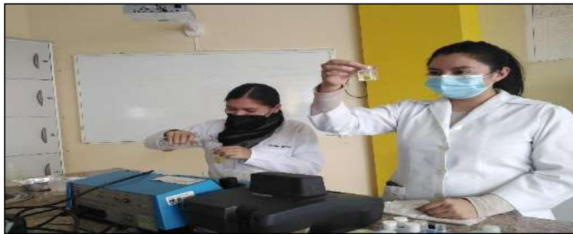
Figura 29-2: Análisis de Sulfatos en el espectrofotómetro de HACH
