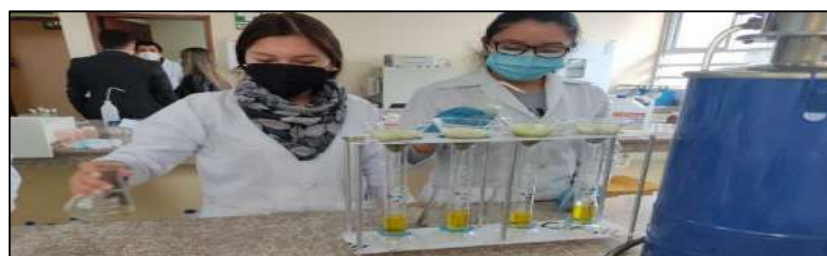
Figura 25-2: Filtrado de las muestras para el análisis de metales pesados
