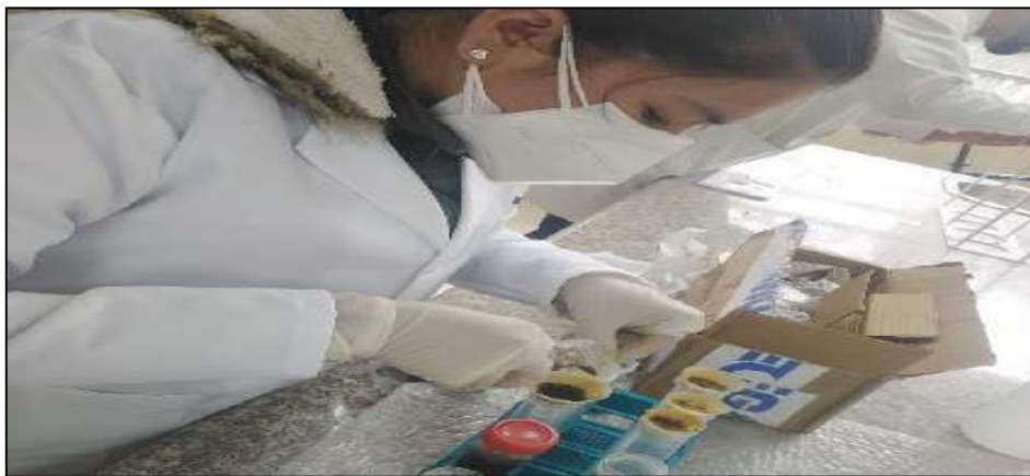
Figura 16-2: Filtrado de muestras para el análisis de conductividad eléctrica
