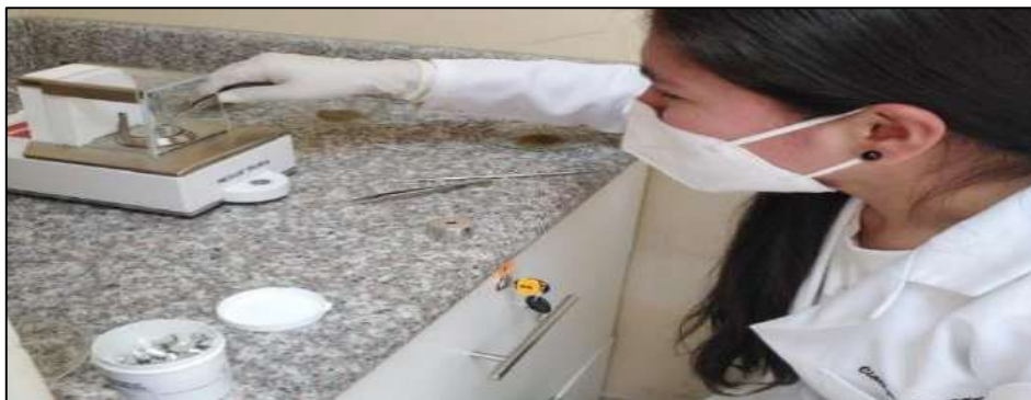
Figura 18-2: Pesaje de muestras para la determinación de Carbono y Nitrógeno
