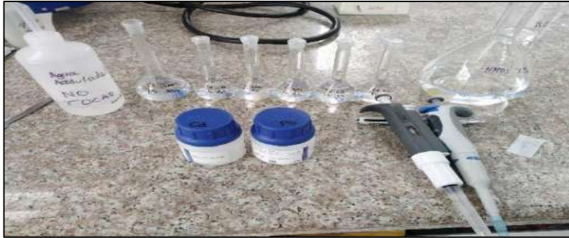
Figura 27-2: Preparación de los estándares para el análisis de Plomo
