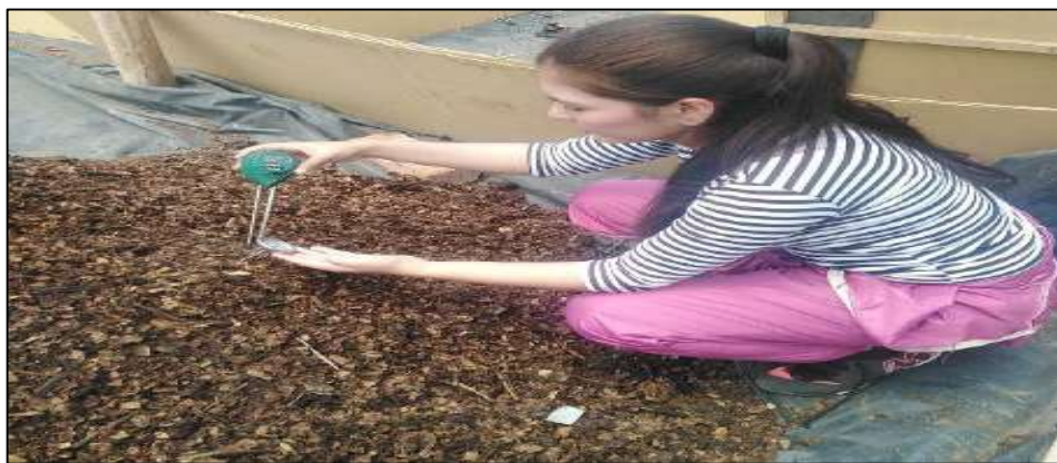
Figura 9-2: Toma de datos de temperatura y humedad de las pilas de compostaje
