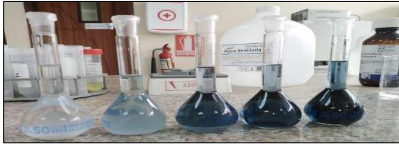
Figura 22-2: Estándares para calibrar el espectrofotómetro UV-VIS
