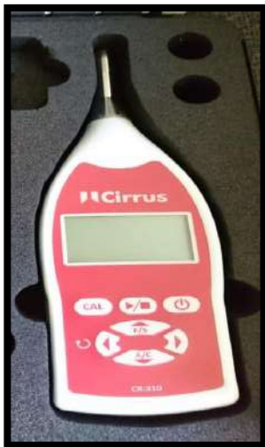
Sonómetro, Marca Cirrus, Modelo CK 382, Serie SH01009, Clase 2 Calibrador, Marca Cirrus, Modelo CK382, Serie PTB-1.61-4028829. Impresora, Marca Cirrus, Modelo CK 382.
