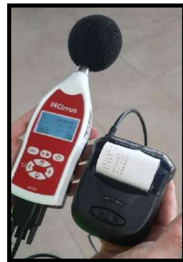
Sonómetro, Marca Cirrus, Modelo CK 382, Serie SH01009, Clase 2 Calibrador, Marca Cirrus, Modelo CK382, Serie PTB-1.61-4028829. Impresora, Marca Cirrus, Modelo CK 382.
