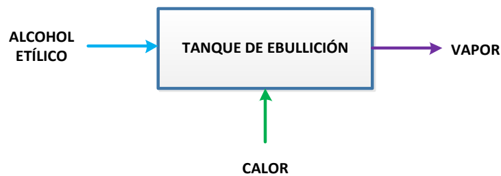
Gráfico 16-4: Balance de energía tanque de ebullición
