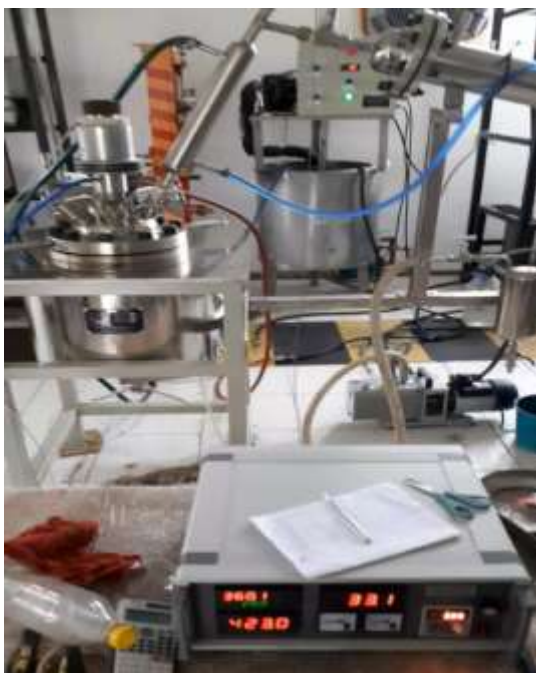
Figura 8-2: Control automático del reactor
