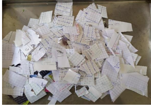
Figura 3-3: Troceado de materia prima para obtención de papel blanco.
