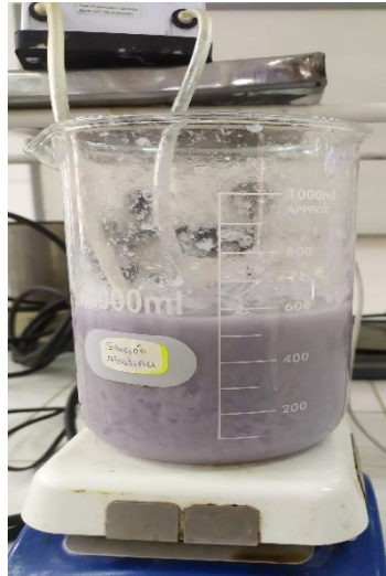
Figura 6-3: Destintado de papel reciclado
