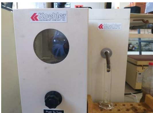
Figura 8-2: Proceso de destilación para la fracción líquida de co-pirólisis
