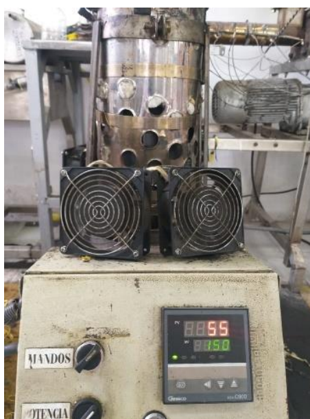
Figura 6-2: Arranque del reactor de pirólisis
