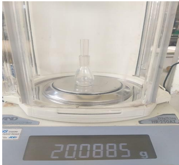
Figura 2-2: Determinación de densidad por medio de un picnómetro
