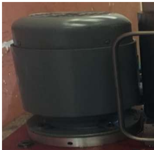
Figura 11-4. Motor eléctrico 110v monofásico
