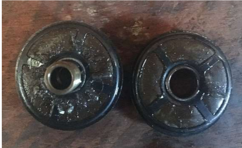
Figura 3-3. Filtros circulares recubiertos con una membrana sintética
