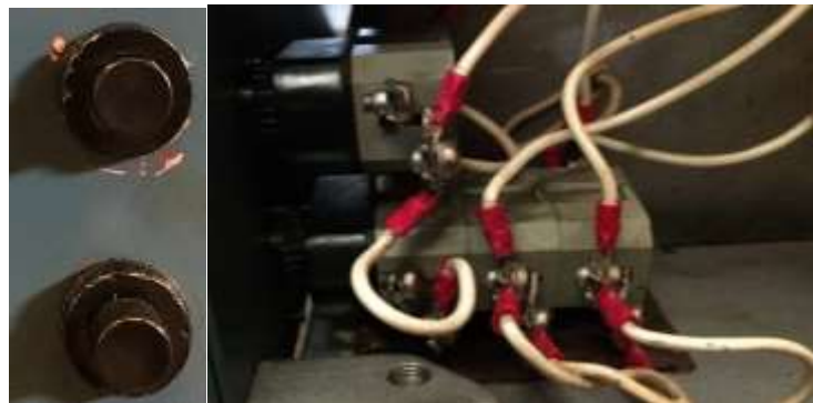
Figura 13-3. Pulsadores para elevar o descender el pistón
