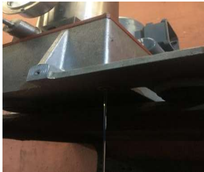
Figura 2-3. Drenado del aceite hidráulico Móvil DTE 18
