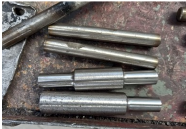
Figura 1-3: Barras de acero AISI 304, AISI M303 y AISI 4140
