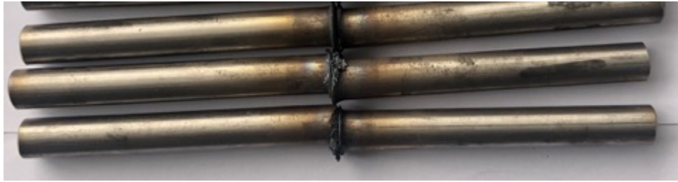
Figura 11-3: Probetas soldadas en etapa de experimentación
