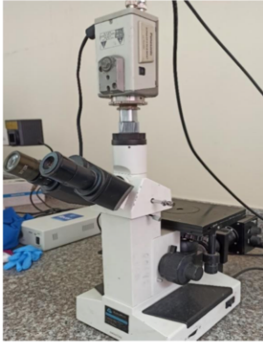
Figura 13-3: Microscopio óptico Buehler Ltd
