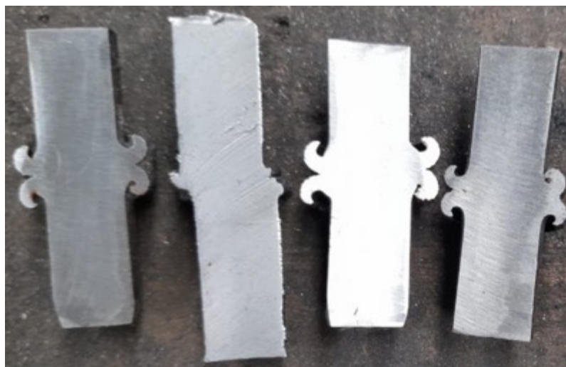
Figura 15-3: Probetas soldadas y cortadas listas para ser pulidas
