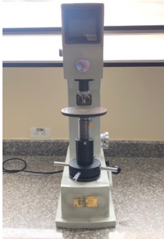
Figura 14-3: Equipo para medición de dureza Rockwell
