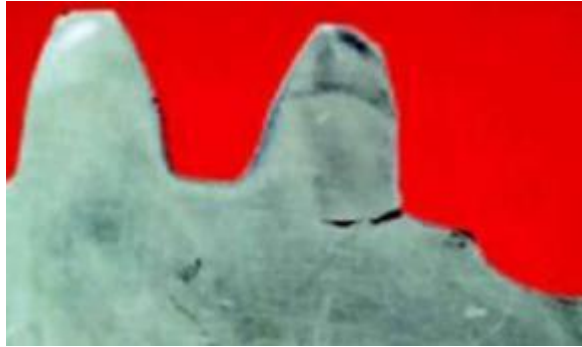
Figura 7-2: Fractura por fatiga de inflexión
