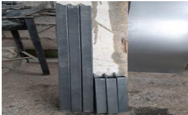
Figura 19-3: Desbaste y limpieza de tubos Realizado por: Moreno, G.; Pilco, V. 2022
