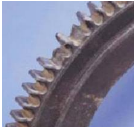
Figura 8-2: Fractura por sobrecarga
