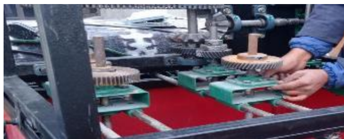
Figura 35-3: Montaje de engranajes helicoidales en los ejes Realizado por: Moreno, G.; Pilco, V. 2022
