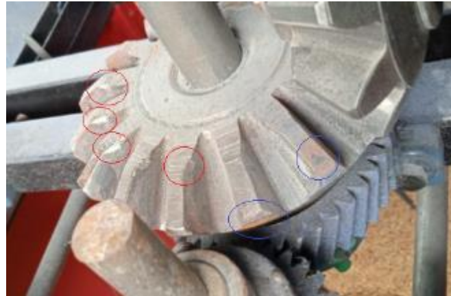
Figura 64-3: Picaduras destructivas y desprendimientos, desgaste por corrosión
