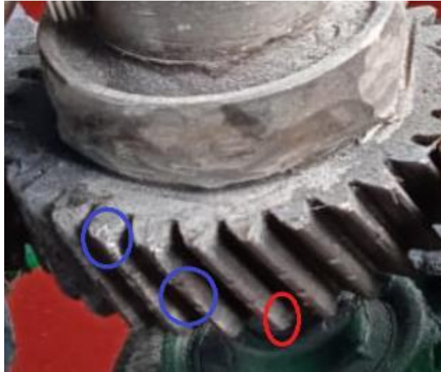
Figura 69-3: Picado inicial, desprendimiento de partículas.
