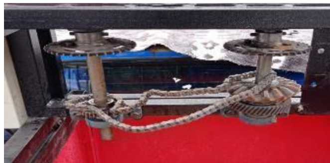
Figura 32-3: Montaje del sistema de transmisión de engranajes helicoidales Realizado por: Moreno, G.; Pilco, V. 2022
