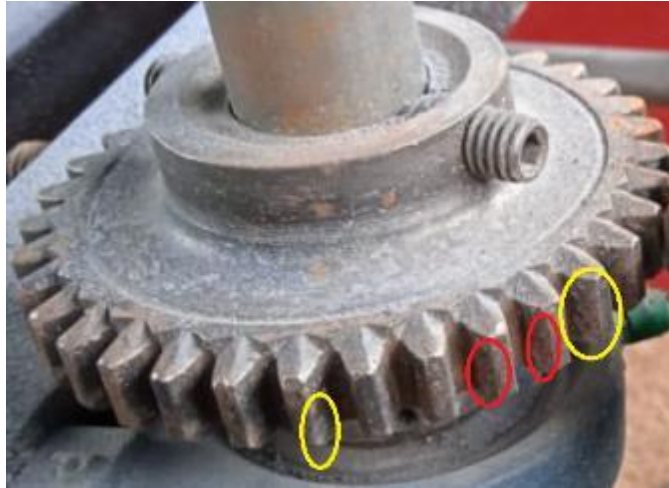
Figura 68-3: Picado destructivo, picado inicial. Realizado por: Moreno, G.; Pilco, V. 2022
