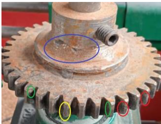
Figura 67-3: Picado destructivo, picado inicial, abrasión, fisura.
