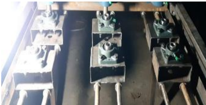
Figura 24-3: Construcción de bases para ejes Realizado por: Moreno, G.; Pilco, V. 2022
