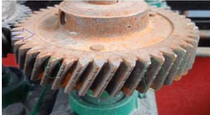
Figura 65-3: Desgaste superficial, picaduras iniciales, abrasión, corrosión.
