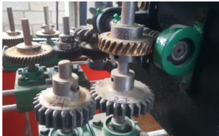
Figura 11-3: Diseño de tornillo sin fin – corona Realizado por: Moreno, G.; Pilco, V. 2022
