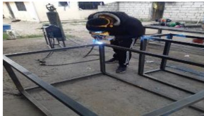
Figura 21-3: Soldadura de la estructura Realizado por: Moreno, G.; Pilco, V. 2022
