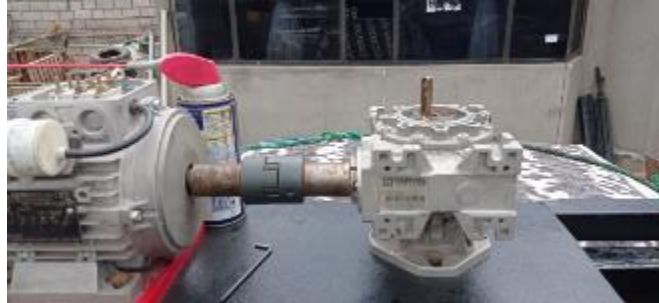
Figura 60-3: Caja reductora y motor Realizado por: Moreno, G.; Pilco, V. 2022
