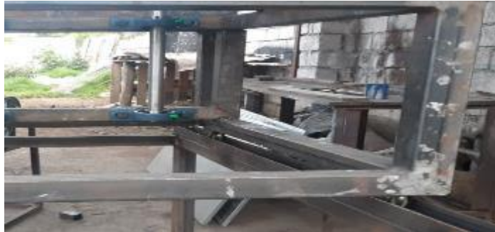
Figura 23-3: Acoplamiento de tubos en la estructura superior Realizado por: Moreno, G.; Pilco, V. 2022
