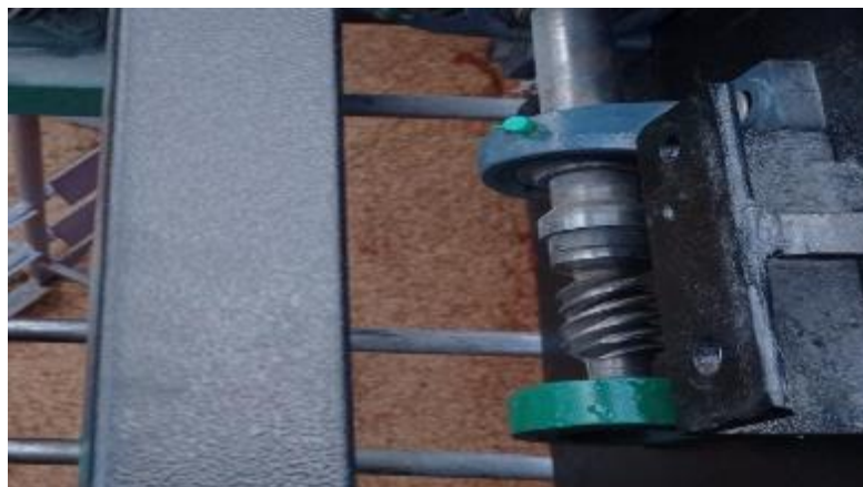
Figura 37-3: Montaje del sistema de transmisión por tornillo sin fin Realizado por: Moreno, G.; Pilco, V. 2022
