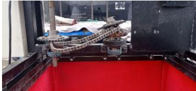
Figura 61-3: Desmontaje del eje Realizado por: Moreno, G.; Pilco, V. 2022
