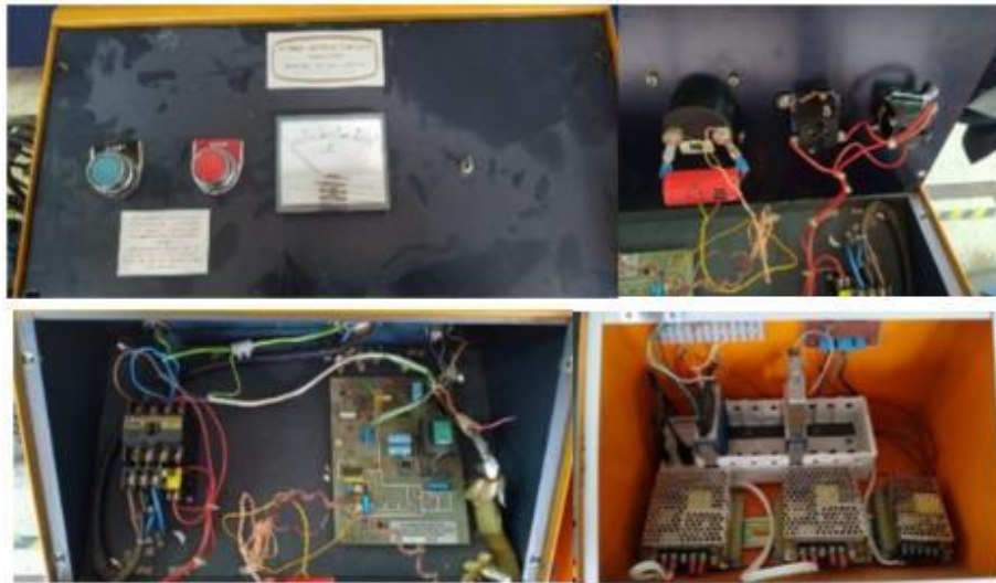
Figura 1-3: Circuito de potencia y circuito de mando
