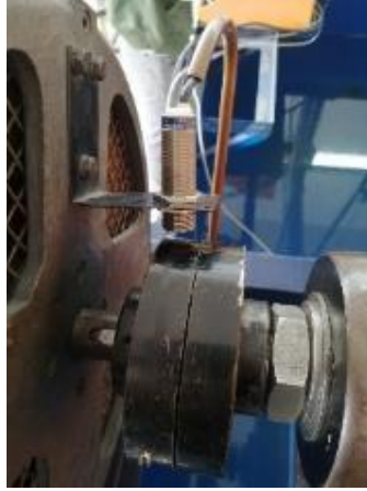
Figura 4-3: Instalación del sensor de proximidad
