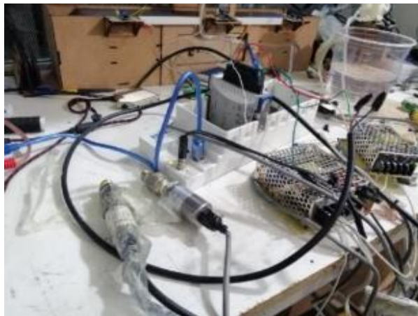
Figura 2-3: Proceso de calibración de los transductores de presión
