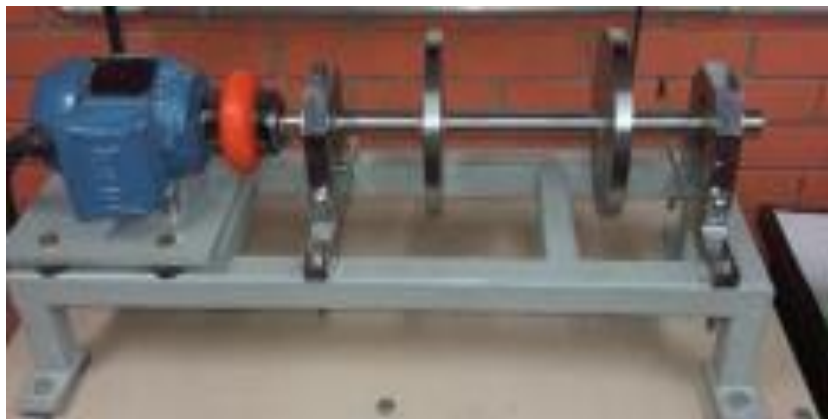
Figura 7-2: Módulo de pruebas para simular modos de falla
