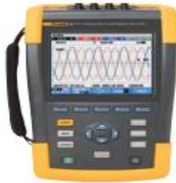
Figura 6-2: Analizador de la calidad eléctrica
