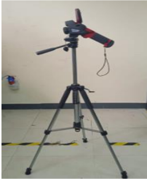
Figura 5-3: Soporte de la cámara termográfica
