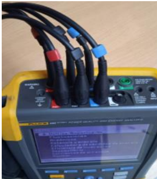
Figura 10-3: Conexión en el analizador de energía y calidad eléctrica
