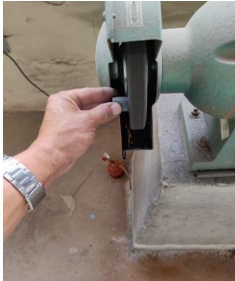
Figura 2-4: Limpieza de probetas
