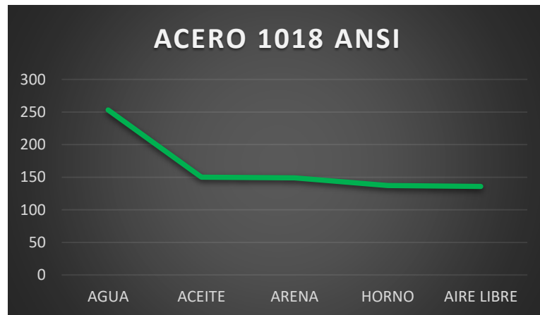
Gráfico 2-4: Dureza acero ANSI 1018
