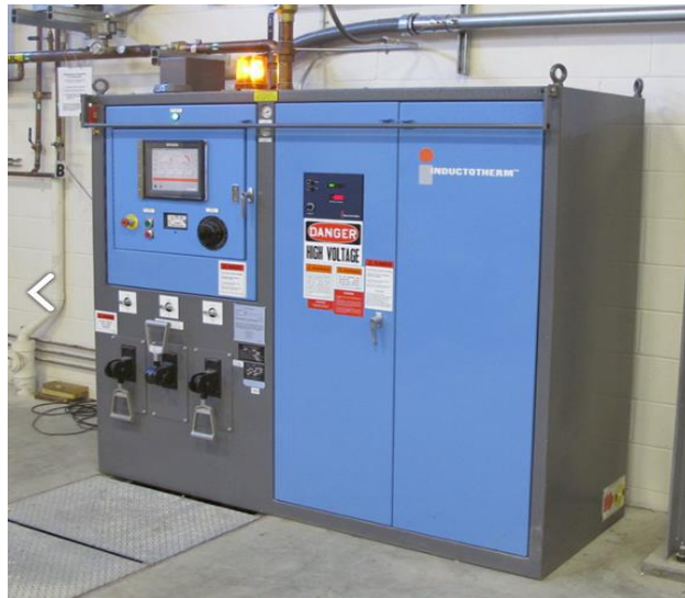
Figura 4-2: Horno de calentamiento por inducción electromagnética
