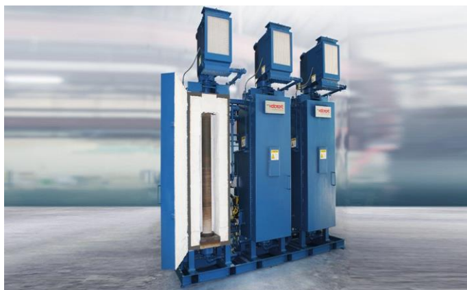
Figura 6-2: Horno de atmósfera tipo generado exotérmico y endotérmico
