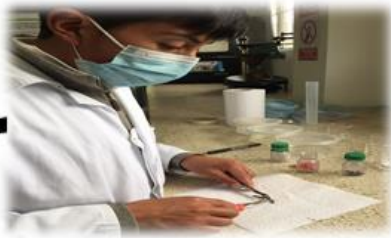
Se realizó cortes de 5 a 8 mm de la zona afectada
