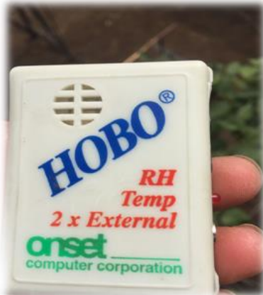
Instalación de Datalogger HOBO® para la recolección de datos de temperatura y HR
