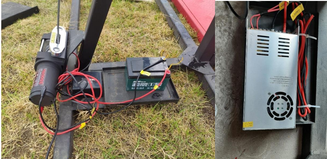
Figura 102-3: Conexión del winch a batería de 12 v
