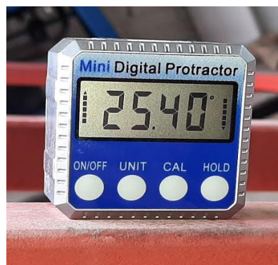
Figura 20-2: Inclinómetro magnético digital
