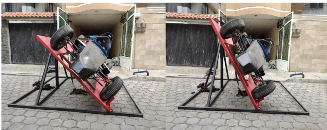
Figura 1-4: Prueba basculante a 45 y 60 grados con Fórmula SAE
