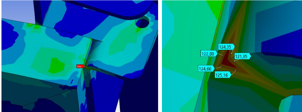
Figura 62-3: Punto de singularidad en el apoyo
