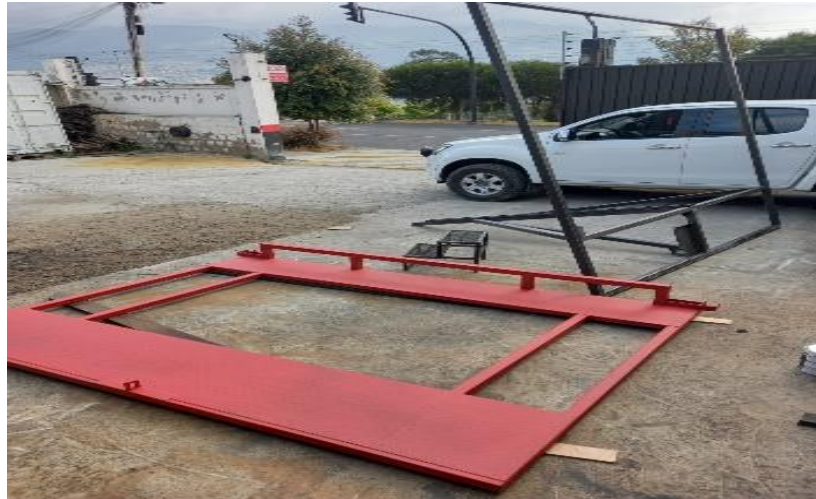
Figura 94-3: Aplicación de la pintura y secado
