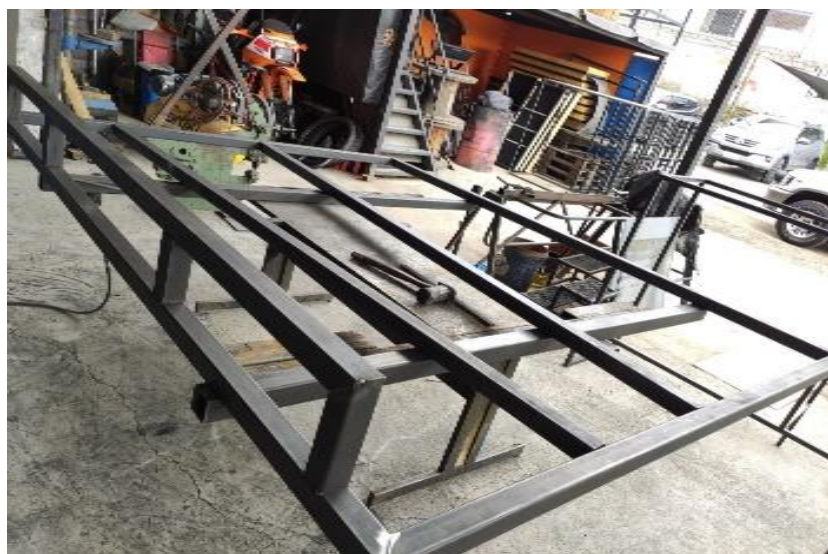
Figura 87-3: Tubos verticales de la base
