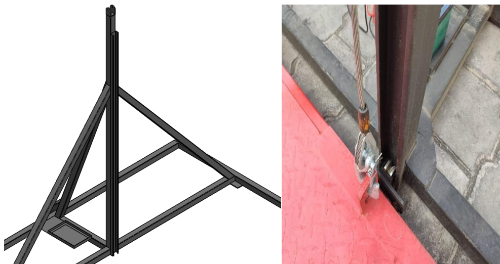
Figura 81-3: Correa en G utilizada como riel para la plataforma
