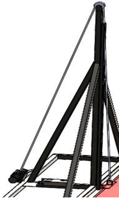
Figura 100-3: Sistema de sujeción entre el motor y la plataforma
