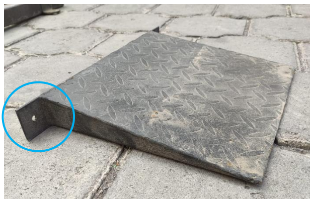
Figura 91-3: Estructura de base con platinas laterales perforadas
