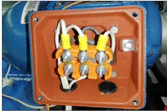
Figura 24-3: Conexión D del motor trifásico
