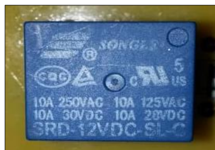
Figura 19-3: Relay del variador
