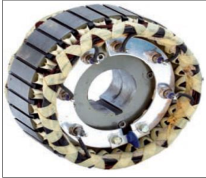
Figura 5-2: Detalle del estator
