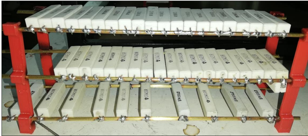
Figura 25-3: Paquete de resistencias en paralelo
