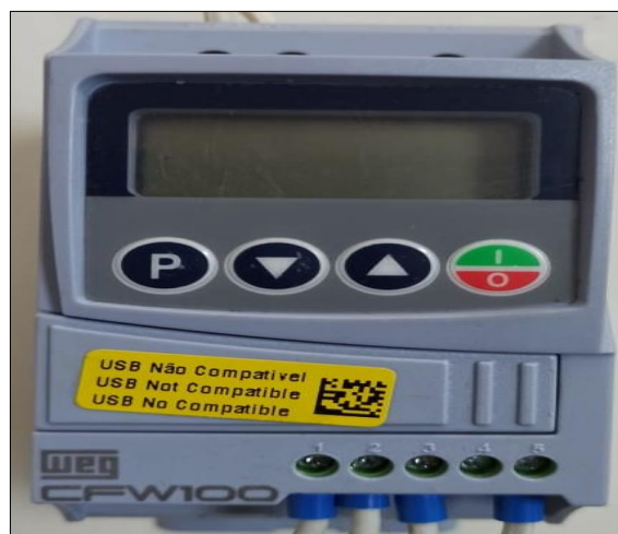
Figura 11-3: Variador de Frecuencia WEG
