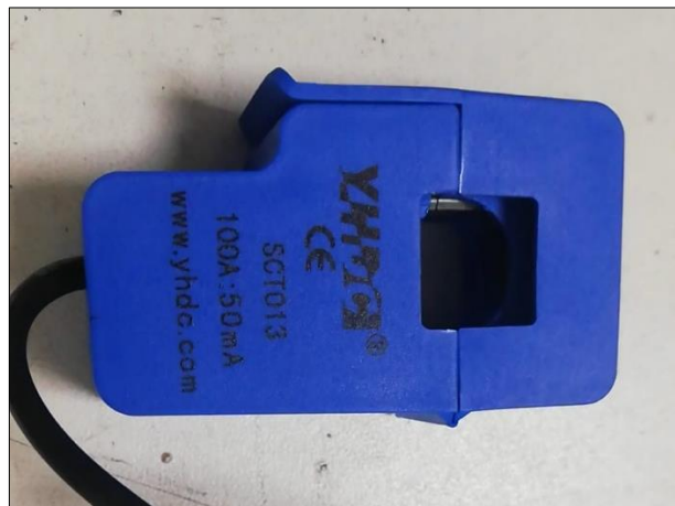
Figura 13-3: Sensor de Corriente
