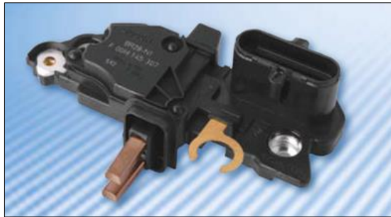
Figura 7-2: Regulador de voltaje
