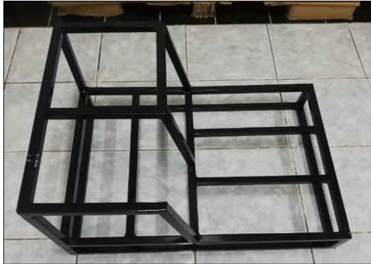
Figura 20-3: Estructura metálica soldada
