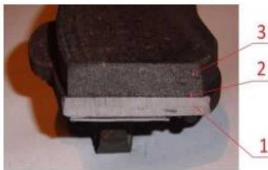
Figura 2-1: Capas de las pastillas de freno
