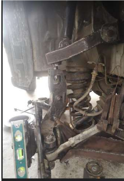
Figura 68-3: Comprobación del ángulo de caída (Caster)
