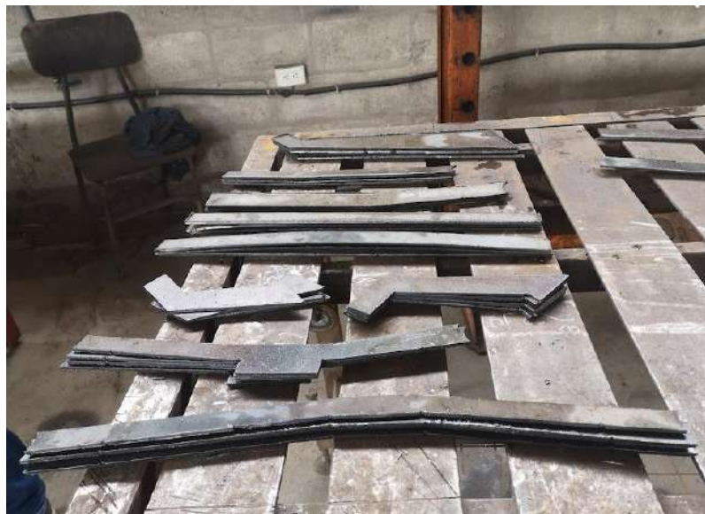
Figura 61-3: Elementos estructurales después del pulido, extracción de escorias.
