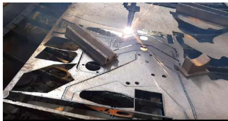
Figura 59-3: Corte con Plasma en la maquina CNC.
