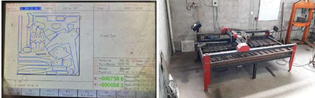
Figura 58-3: Diseños visualizados en la maquina CNC.
