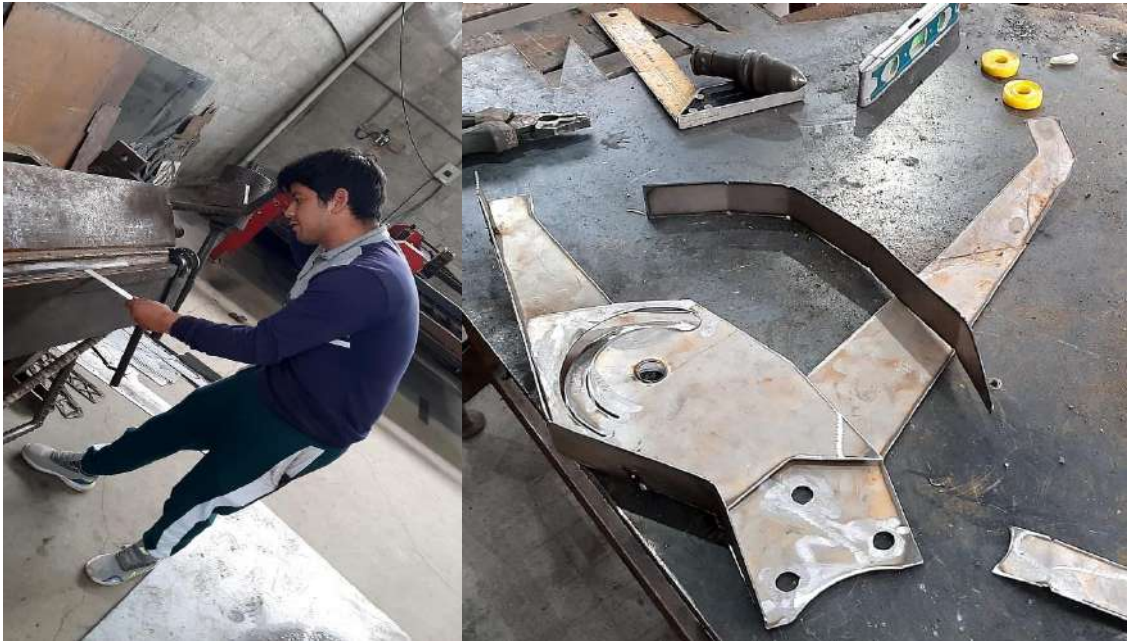
Figura 62-3: Doble de las piezas de acuerdo a los datos del diseño CAD.
