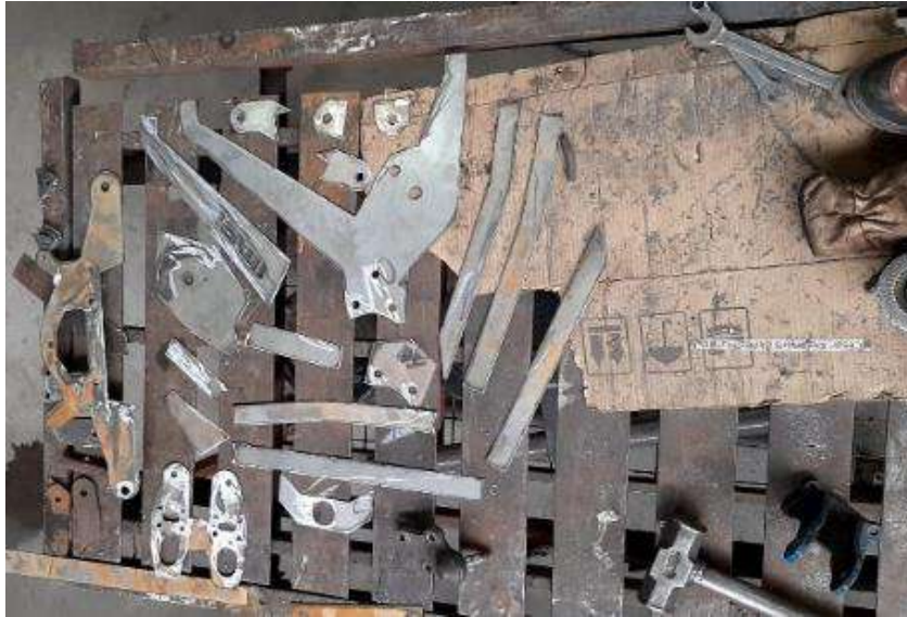
Figura 60-3: Elementos estructurales luego del corte CNC
