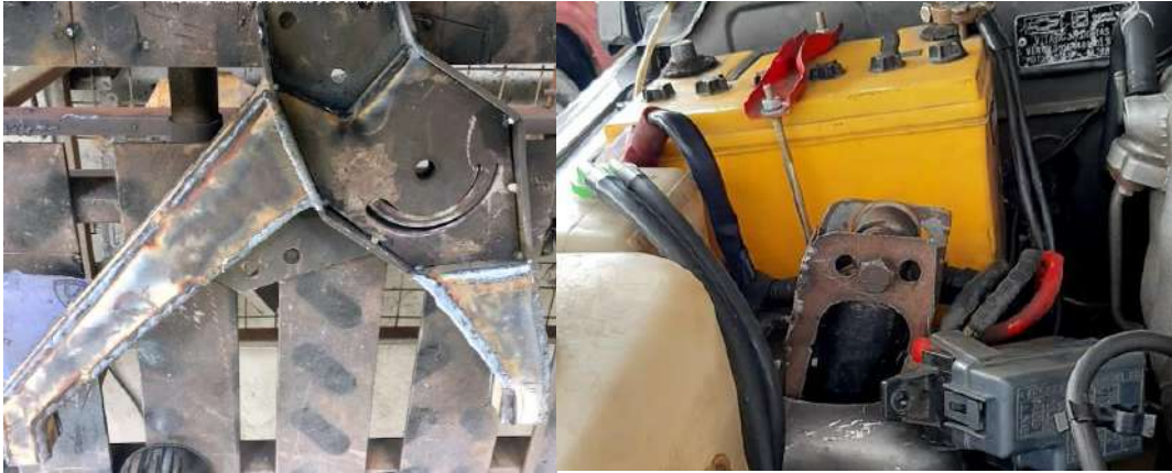
Figura 64-3: Aplicación de cordones de soldadura MIG por cada pieza del sistema.
