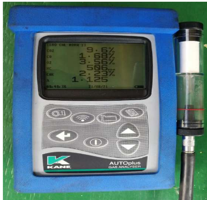
Figura 21-2: Equipo analizador de gases Kane Autoplus 4-2
