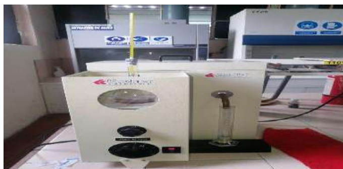
Figura 9-2: Equipo Koehler para destilación fraccionada
