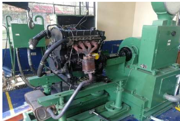
Figura 18-1: Dinamómetro de motor FA 200/30 SP
