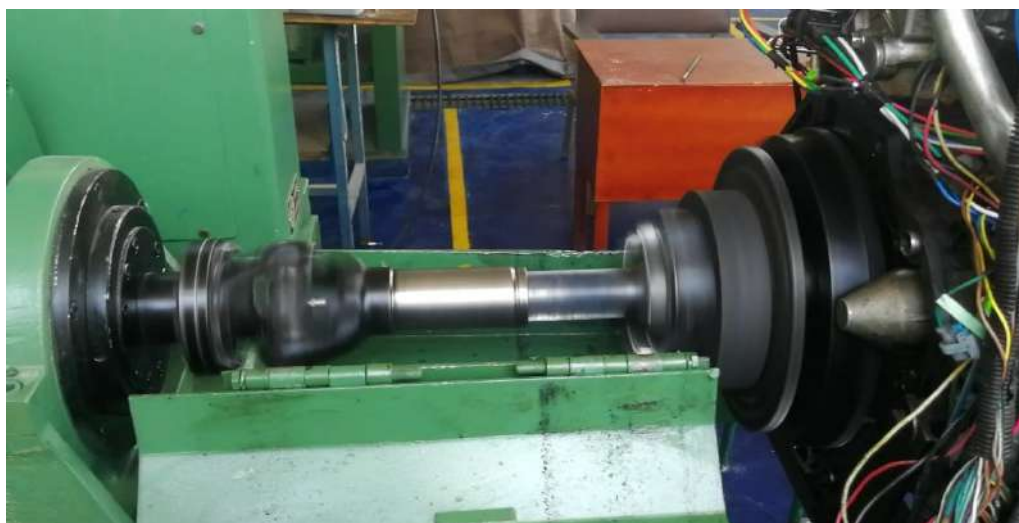
Figura 19-2: Conexión directa entre el estator y eje principal del motor (junta cardán)
