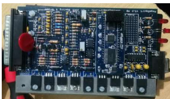
Figura 11-2: Placa electrónica MegaSquirt II
