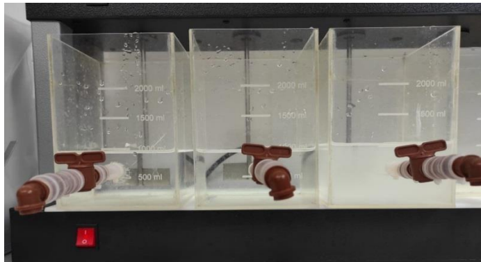
g. Test de jarras con oxido de aluminio – alúmina activada
