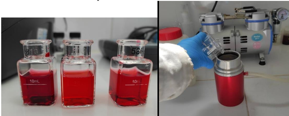
i. Análisis de fluoruros del filtro al vacío con oxido de aluminio
