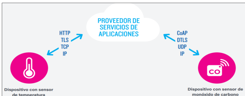
Figura 3-1. Modelo de comunicación “Dispositivo a la Nube”
