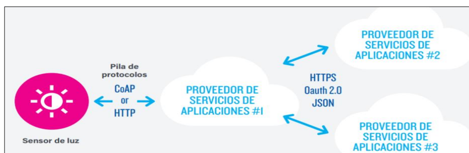
Figura 5-1. Modelo de intercambio de datos a través del back end
