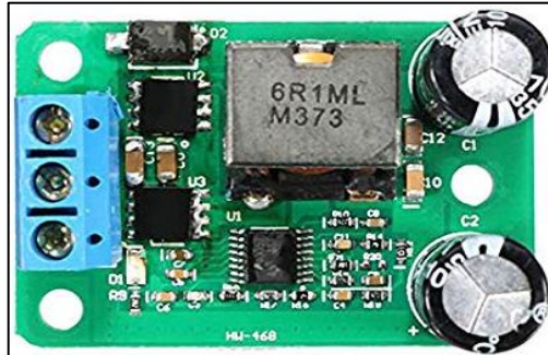
Figura 7-2. Fuente Conmutada DC – DC
