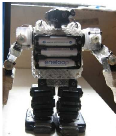
Figura VI.6 Baterías parte frontal
