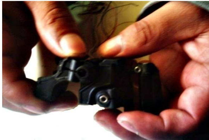
Figura V.12. Unión de la rodilla con el siguiente micromotor (cadera)
