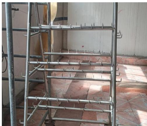
**Figura 3-3:** Coche para el transporte de hígados y buffets del ovino
