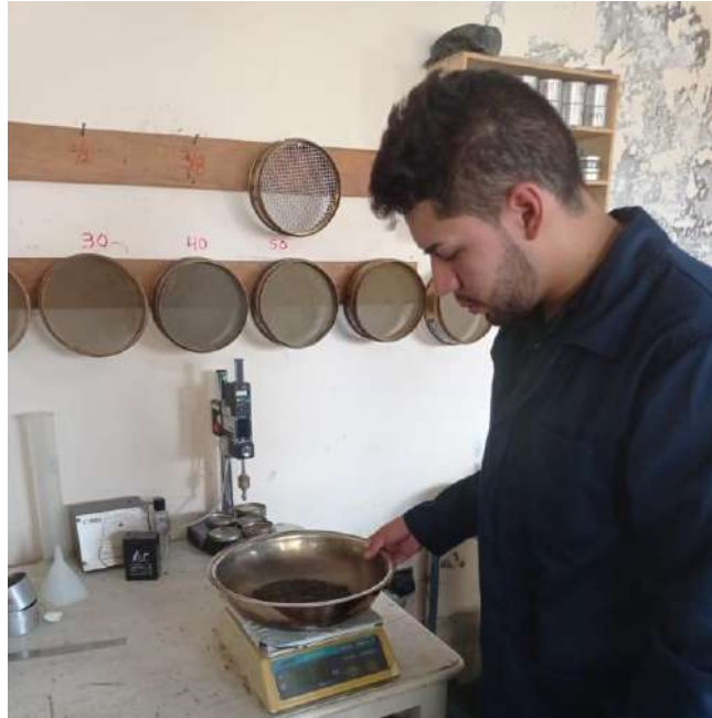
Figura 4-3: Pesado del tamaño de grano de los tamices
