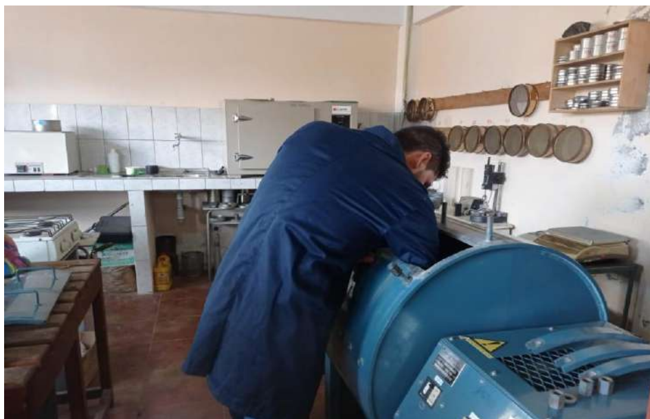
Figura 6-3: Colocación de muestras en la máquina de abrasión Los Ángeles
