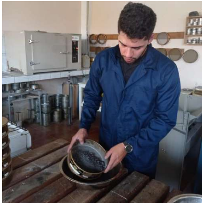
Figura 3-3: Colocación de muestras para ser pesado
