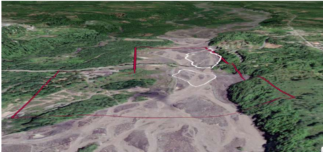
Figura 22-4: Modelado de los bancos de explotación en área minera
