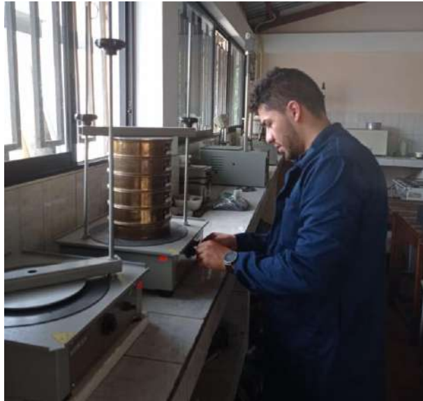
Figura 2-3: Proceso del ensayo de granulometría
