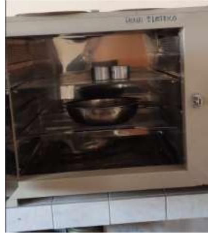
Ensayo de contenido de humedad
