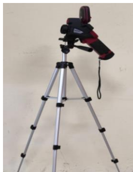
Figura 1-4: Colocación de cámara termográfica
