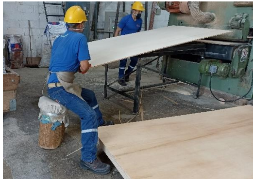
Figura 4-3: Verificación de tableros contrachapados
