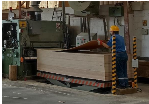
Figura 2-3: Alimentación de lijadora con tableros contrachapados Realizado por: Pacheco J., 2021.
