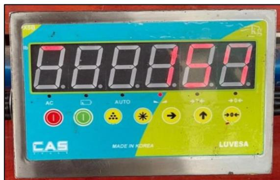
**Figura 11-3:** Imagen de indicador de peso capturada por cámara web.
