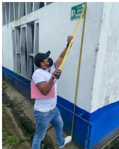
Altura de la señalética de evacuación
