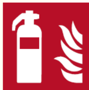
Figura 6-2: Señal de seguridad Fuente: (ISO7010, 2011)
