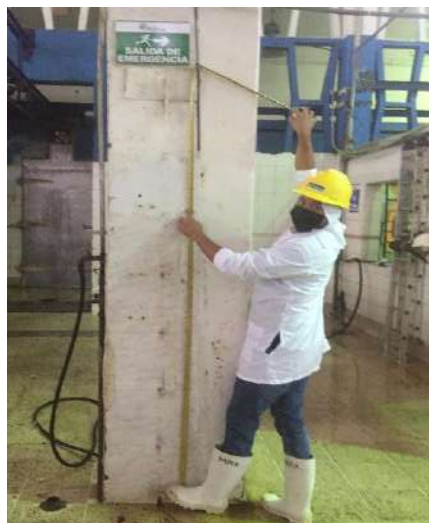
Altura de la señalética de evacuación
