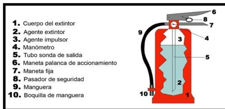
Figura 9-2: Partes del extintor
