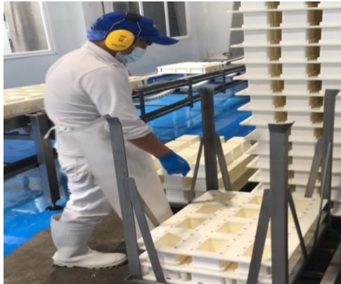
Figura 9-3: Apilamiento de multimoldes
