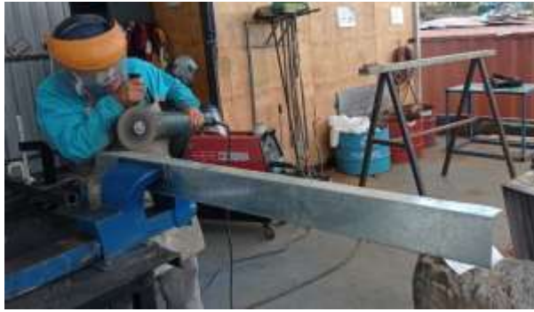
Figura 11-4: Corte de la lámina de aluminio
