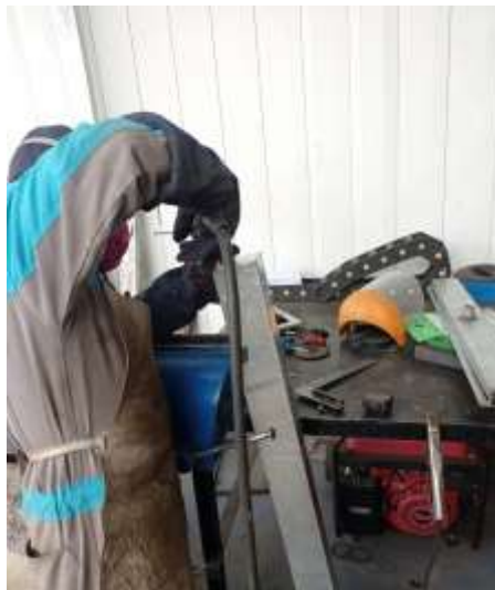
Figura 12-4: Suelda de los extremos de la bandeja
