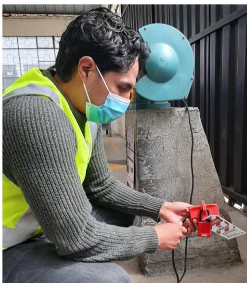
Ilustración 8-4: Implementación de dispositivos LOTO 3.
