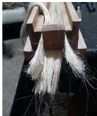
Figura 12-3: Distribución de la fibra larga en el molde
