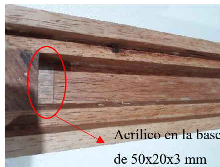
Figura 11-3: Colocación de acrílicos en los extremos
