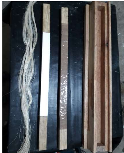
Figura 10-3: Elementos para probeta de fibra larga, ensayo de tracción Realizado por: Guijarro, Graciela. 2020.
