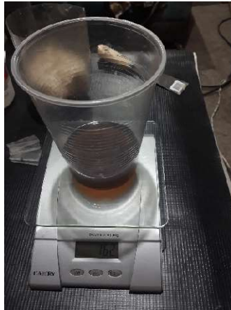
Figura 13-3: Medición en masa de los componentes de la resina Realizado por: Guijarro, Graciela. 2020.
