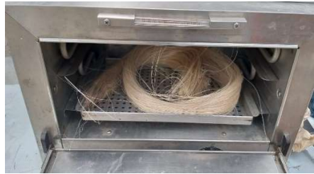
Figura 3-3: Secado de la fibra Realizado por: Guijarro, Graciela. 2020.
