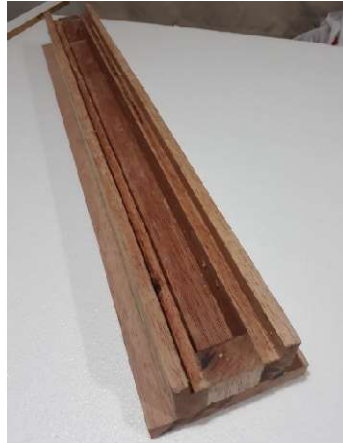
Figura 9-3: Molde limpio y encerado Realizado por: Guijarro, Graciela. 2020.
