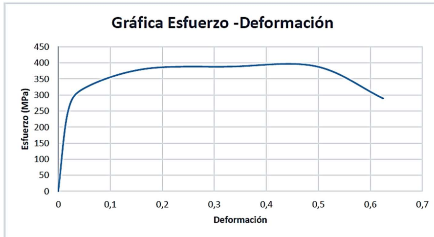
Figura 6-4: Diagrama Esfuerzo - Deformación del Acero ASTM A500 Fuente: (López S. , 2016)
