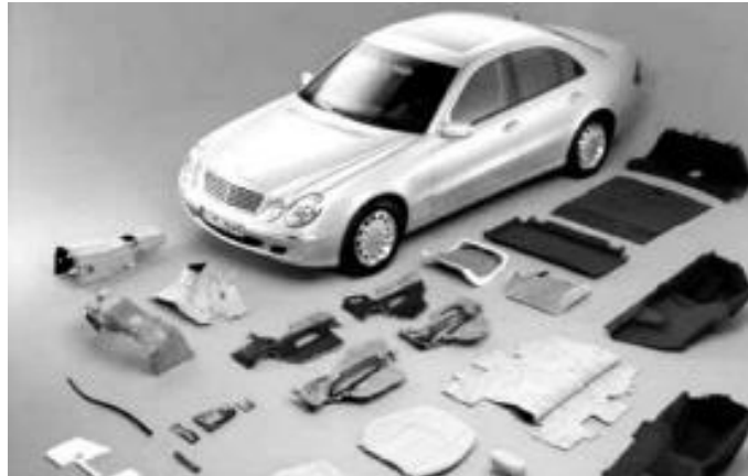
Figura 1-2: Partes de un automóvil Mercedes Benz elaboradas con fibras vegetales
