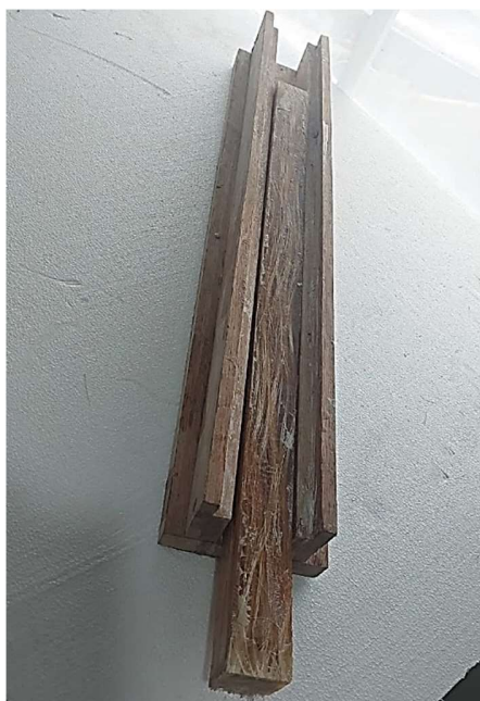
Figura 15-3: Desmoldado de la probeta Realizado por: Guijarro, Graciela. 2020.
