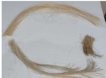
Figura 2-3: Descabezado y despuntado de la fibra Realizado por: Guijarro, Graciela. 2020.
