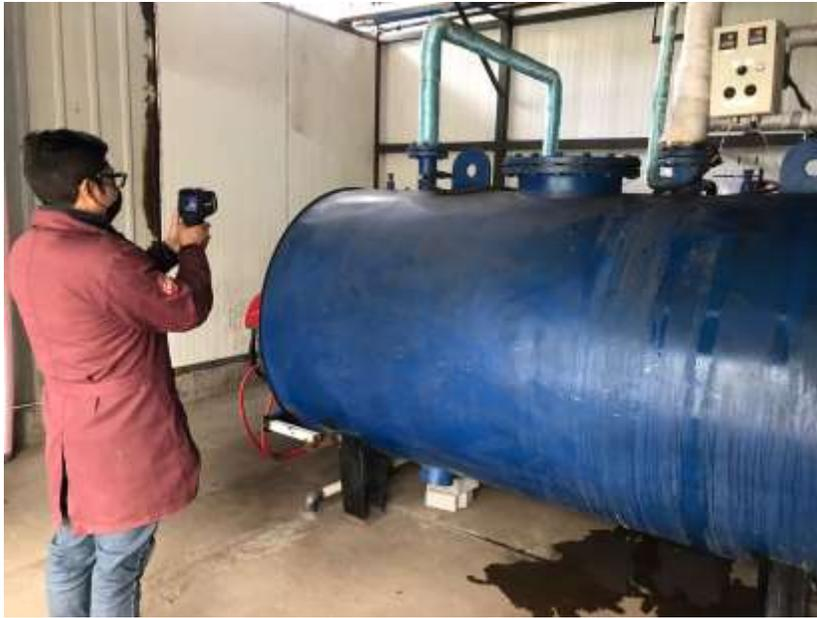
**Ilustración 3-3:** Toma de temperatura a la salida de la caldera.
