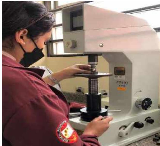
**Ilustración 29-3:** Uso del durómetro del laboratorio de Materiales -ESPOCH
