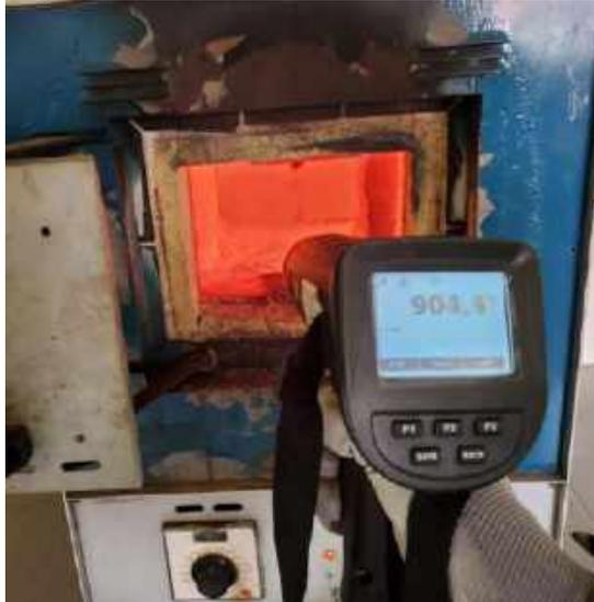
**Ilustración 10-3:** Control de temperatura a 900°C
