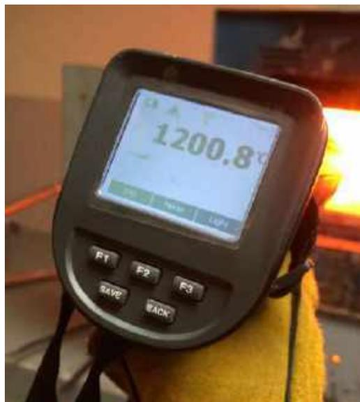
**Ilustración 13-3:** Control de temperatura a 1200°C
