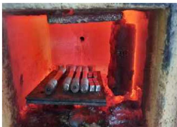
**Ilustración 9-3:** Grupo de probetas en el horno
