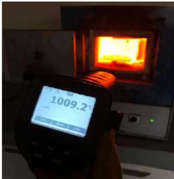
**Ilustración 11-3:** Control de temperatura a 1000°C
