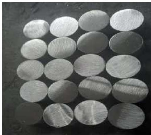
**Ilustración 15-3:** Muestras de acero AISI 1018 cortadas
