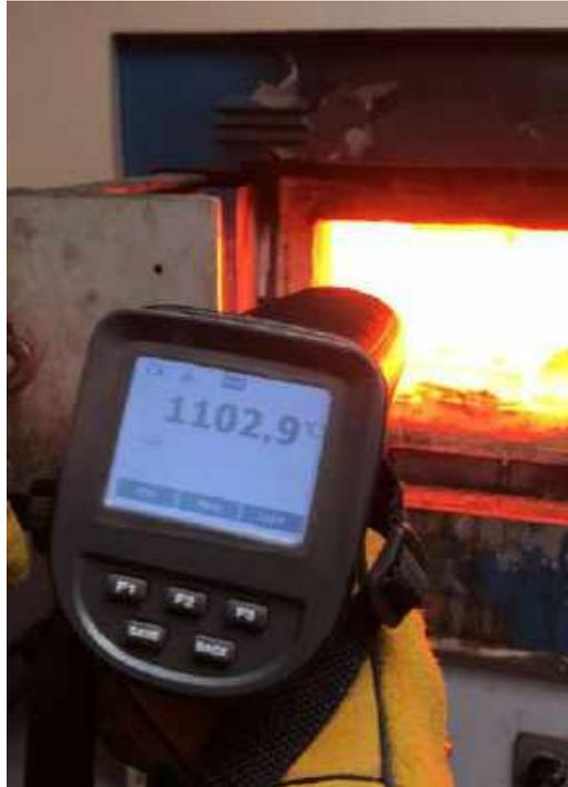
**Ilustración 12-3:** Control de temperatura a 1100°C
