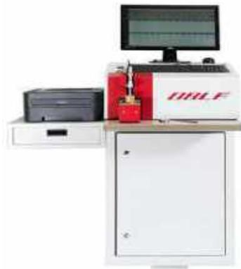
**Ilustración 8-2:** Espectrómetro de emisión de chispa.
