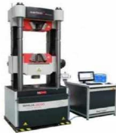
**Ilustración 15-2:** Máquina universal de ensayos
