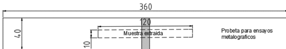
Ilustración 19-3. Disposición y dimensiones en mm de muestra extraída
