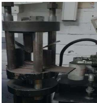
Ilustración 18-3: Doblado de cara
