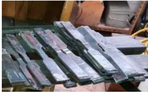
Ilustración 17-3: Probetas mecanizadas para ensayo de tracción
