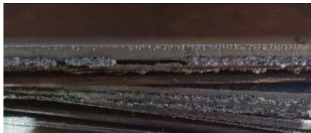
Ilustración 5-3: Placas cortadas con escoria
