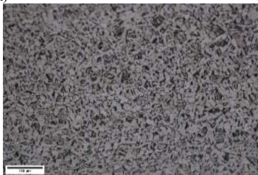
Ilustración 12-4: Metalografía FCAW-200-6-Me. Amp:10X. (a) MA, (b) ZAC y (c) MB.
