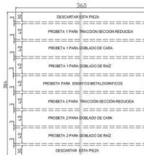
Ilustración 13-3: Dimensiones en mm de probetas
