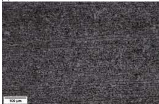
Ilustración 18-4: Metalografía FCAW-225-10.-Me. Amp:10X. (a) MA, (b) ZAC y (c) MB.
