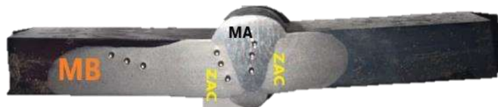
Ilustración 23-3: Probeta con indentaciones en zonas específicas
