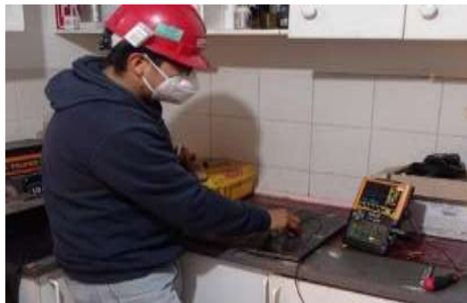
Ilustración 12-3: Ejecución de UT SINDES S.A.
