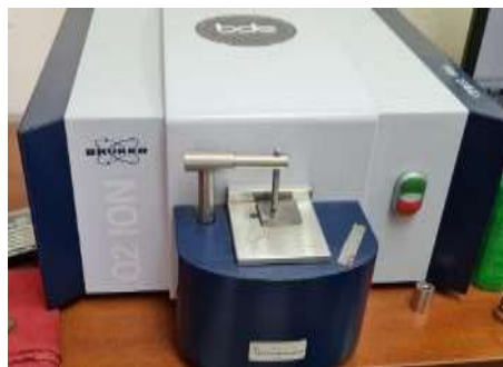
Ilustración 8-3: Muestra colocada en el equipo
