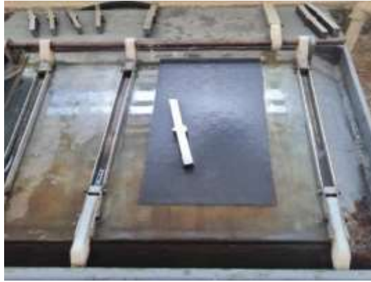
Ilustración 20-3: Probeta en el banco de desbaste
