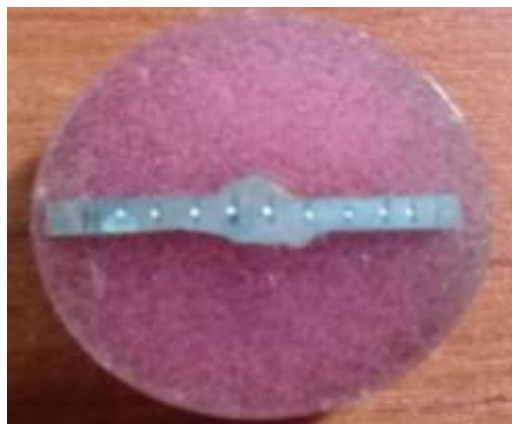
Ilustración 1-2: Muestra de acero en un disco de resina
