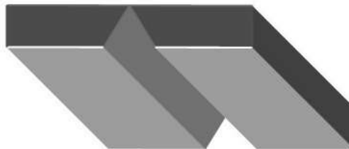
Ilustración 5-2: Posición sobre cabeza
