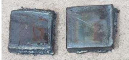
**Ilustración 7-3:** Probetas para espectrometría
