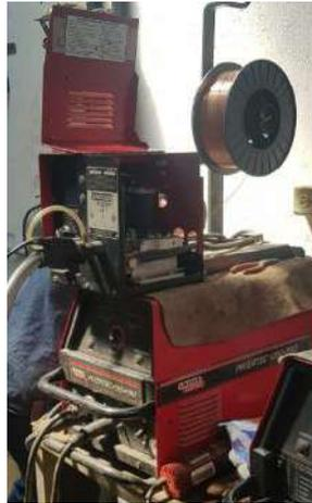
**Ilustración 8-3:** Soldadora Inverter V350 PRO
