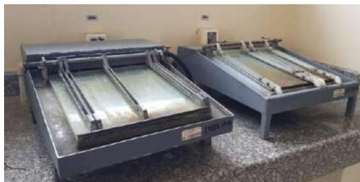
**Ilustración 27-3:** Bancos de lijado manual
