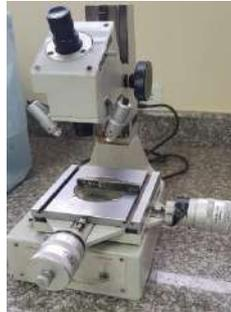
**Ilustración 36-3:** Microscopio MITUTOYO Serie TM
