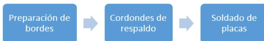
**Ilustración 10-3:** Procedimiento de soldado de placas
