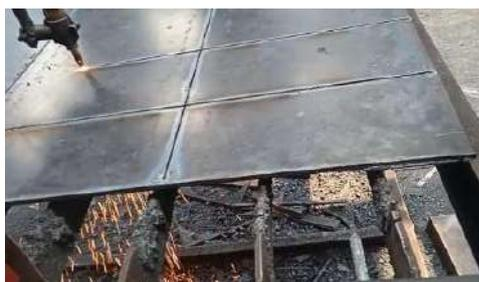
**Ilustración 5-3:** Proceso de corte de las placas
