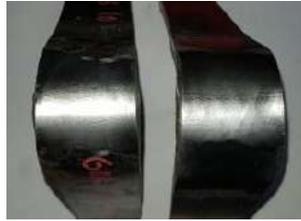
**Ilustración 24-3:** Probetas ensayadas doblez de cara
