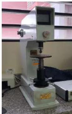
**Ilustración 35-3:** Durómetro Modelo HBRV-187,5
