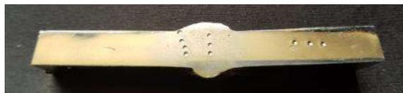
**Ilustración 34-3:** Zonas para medir dureza
