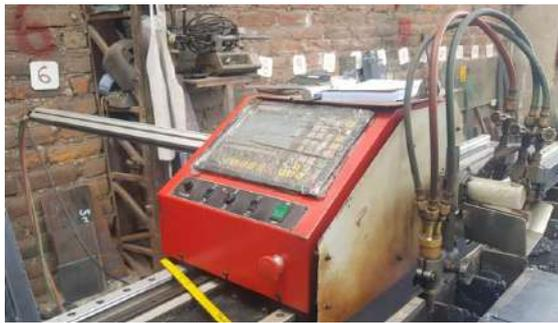
**Ilustración 4-3:** Máquina de oxiacorte PNC-12 Extreme
