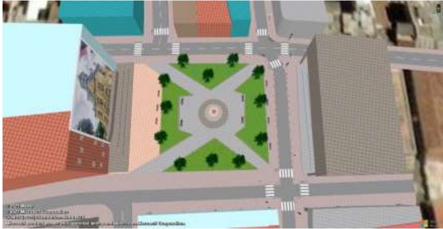
Figura 39-14: Señalización Horizontal en el centro Urbano de Azogues
