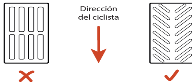
Ilustración 5-2: Dirección de las rejillas de drenaje
