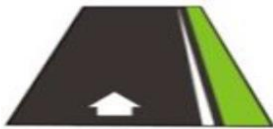
Ilustración 9-2: Líneas de borde de pavimento
