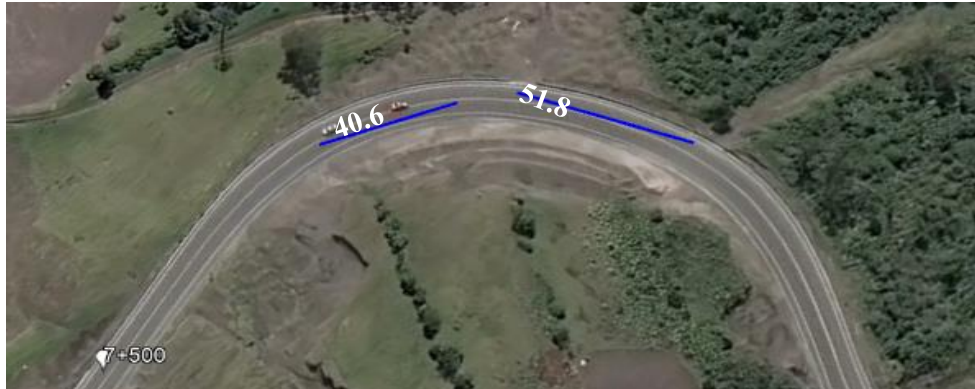
Figura 3-4: Metodología para calcular la distancia de visibilidad
