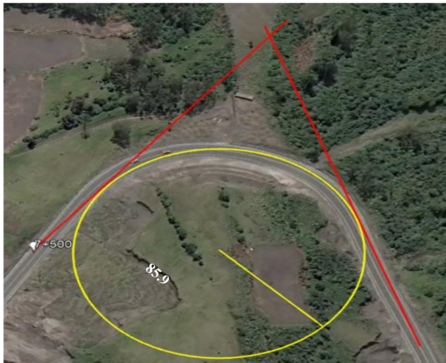
Figura 4-4: Metodología para calcular el radio de curvatura.
