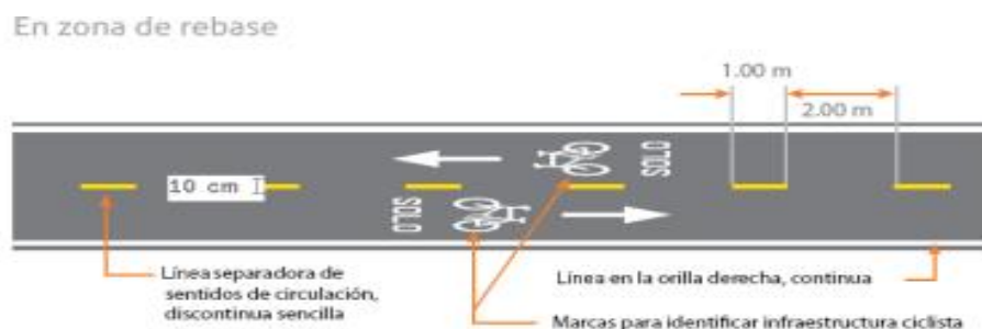
Figura 25-2: Señalización ciclovía segregada para zona de rebasar. Fuente: (INEN, 2011, pág. 57).
